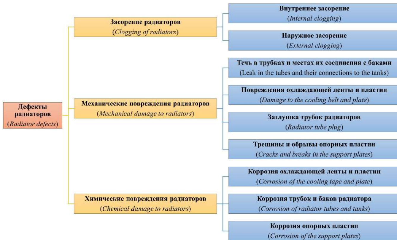
Рис. 4. Классификация дефектов радиаторов системы охлаждения ДВС
